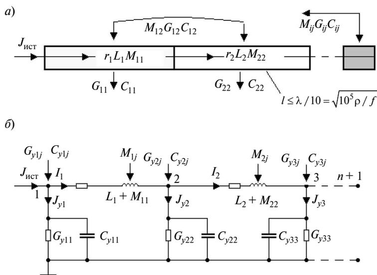
Рис. 1. Полевая (а) и цепная (б) модели стержневого заземлителя
