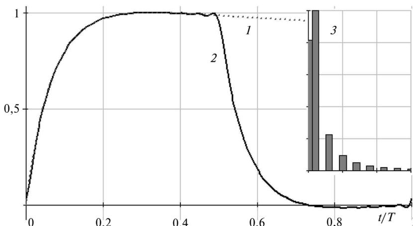
Рис. 3. Импульс тока ( $I$ ) при единичной амплитуде импульса, периодизация (2), АЧХ (3)
