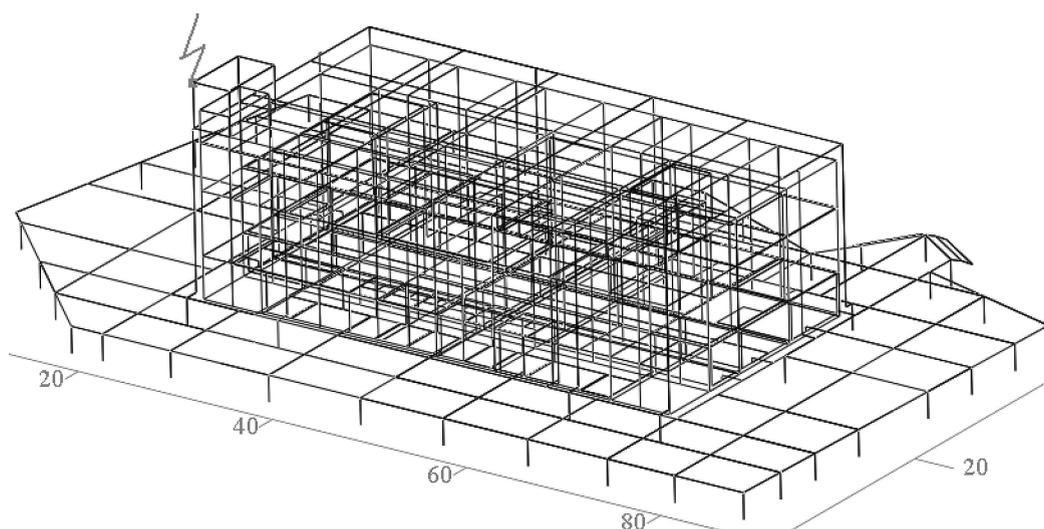
Рис. 5. Геометрическая модель ЗУ электрической подстанции с закрытым распределительным устройством
