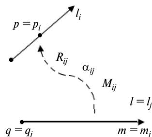
Рис. 2. Определение взаимных параметров  $i, j$ -х элементов с координатами  $q = q_j = (x_q, y_q, z_q)^T$ ,  $m = m_j = (x_m, y_m, z_m)^T$ ,  $l = l_j = m - q$ ,  $p = p_i = (x_p, y_p, z_p)^T$
