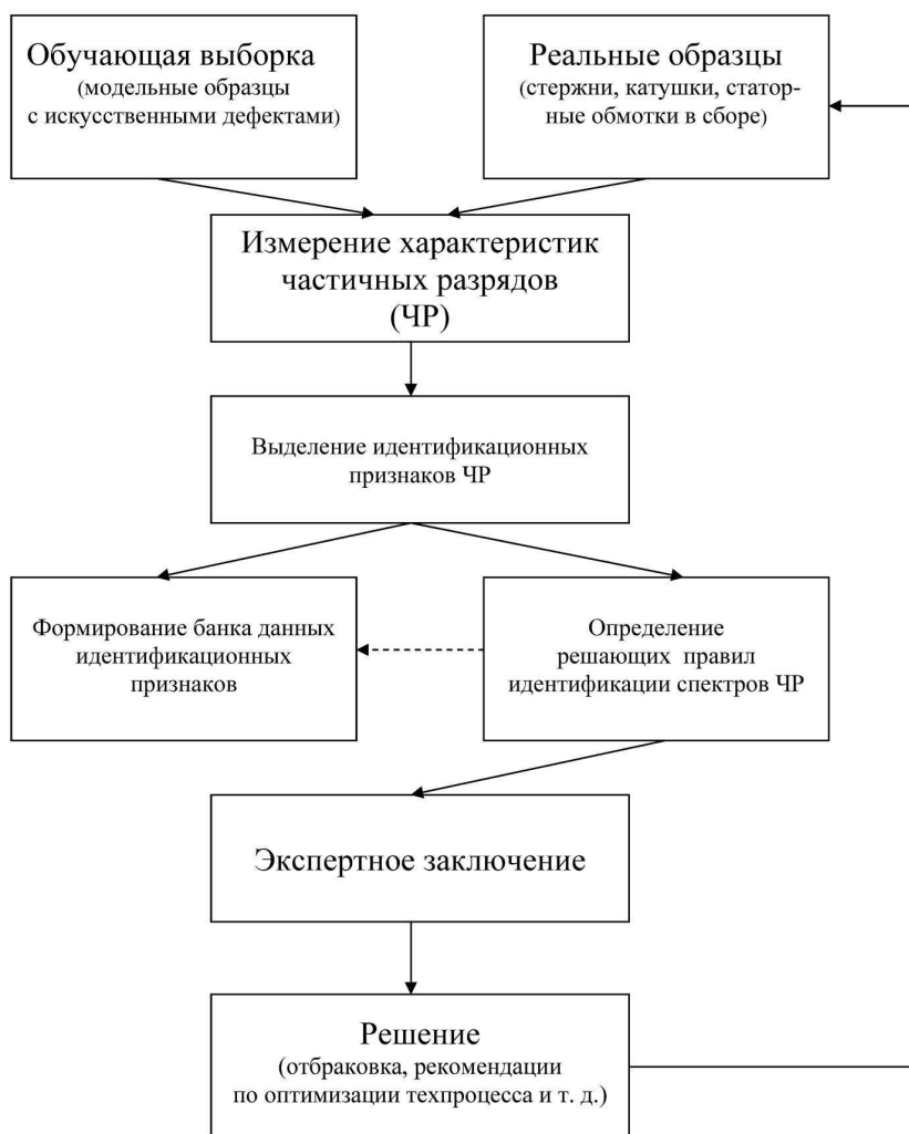
Рис. 1. Блок-схема методики идентификации технологических дефектов в изоляции статорной обмотки электрических машин на стадии заводских приемо-сдаточных испытаний
