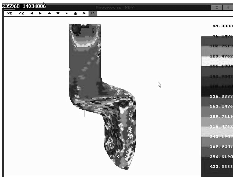
Рис. 24. Распределение интенсивности напряжений \sigma_i в заготовке при РКУП
