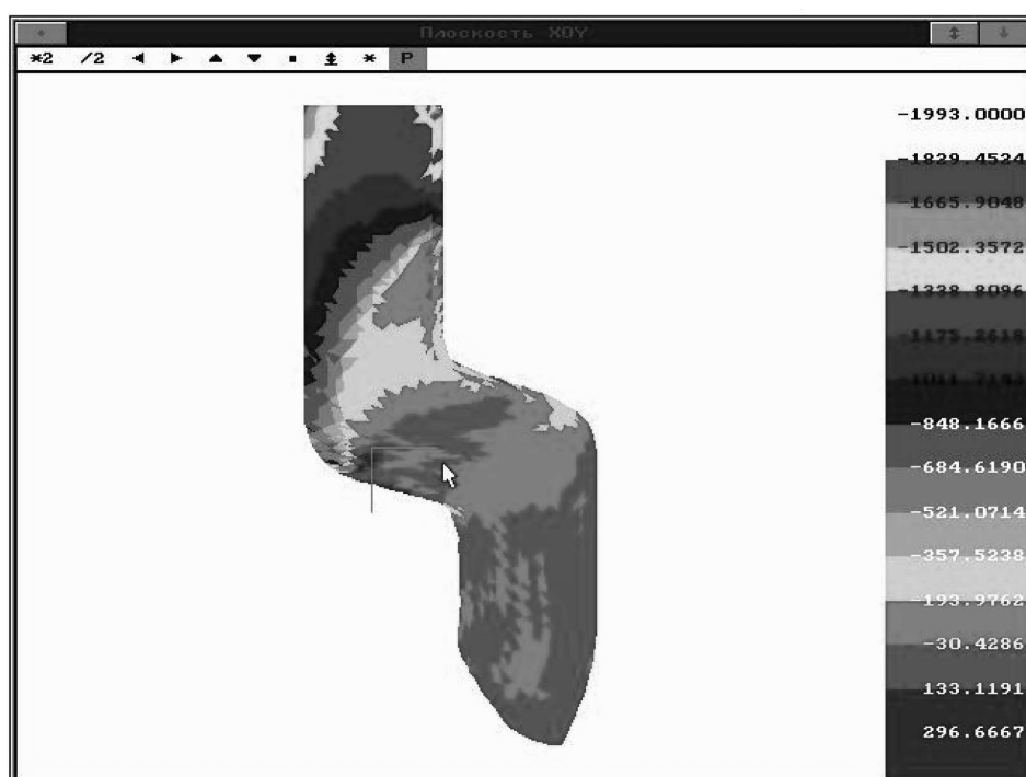
Рис. 20. Распределение напряжений \sigma_y в заготовке при РКУП
