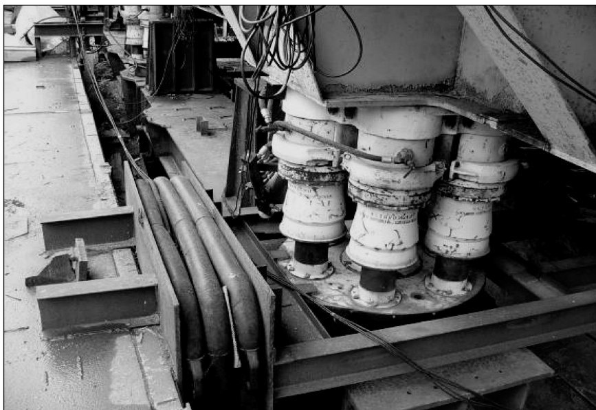
Рис. 2. Пневматическое и пневмогидравлическое устройства для формирования требуемого частотного состава сейсмического воздействия
