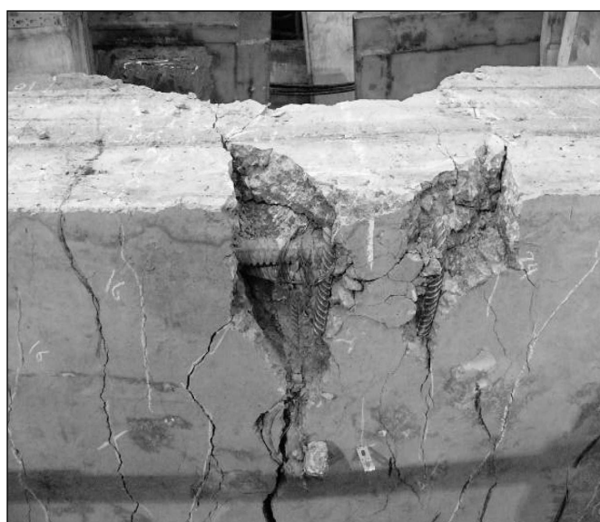
Рис. 6. Разрушение модели при действии предельной нагрузки
