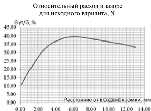
Рис. 13. Изменение относительного расхода через РЗ над РК в зависимости от расстояния от входной кромки
