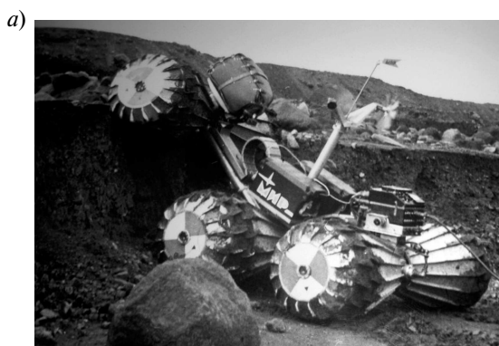
Рис. 5. Ходовые испытания адаптивного макета с переменной геометрией ходовой части на пересеченной местности:
