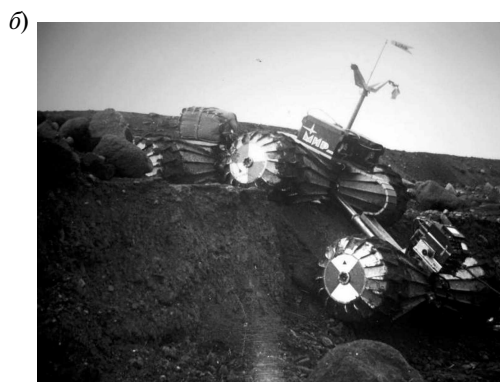
Рис. 5. Ходовые испытания адаптивного макета с переменной геометрией ходовой части на пересеченной местности:
