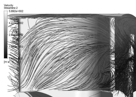
Рис. 7. Линии тока на вогнутой поверхности лопатки РК [9]
