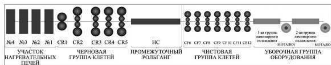
Рис. 1. Структурная схема стана 2000 ОАО «Северсталь»
