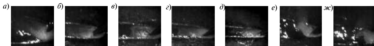
Рис. 5. Кадры скоростной видеосъемки лазерно-дуговой сварки при различном расстоянии (указано в мм) между лучом лазера и электродом: a — 0; b — 1; в — 2; г — 3; д — 3,5; e — 4; ж — 5 мм
