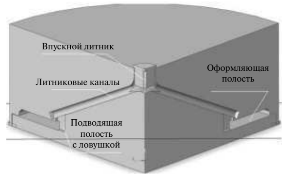
Рис. 1. Трехмерная геометрическая модель пресс-формы (вырез четверти) — копия с экрана
