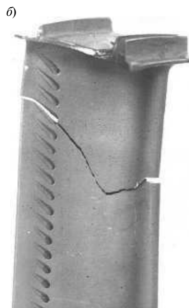
Рис. 11. Зоны зарождения трещин ( a ) и характерные разрушения лопатки ( b ), которые наблюдались при лабораторных исследованиях [31]
