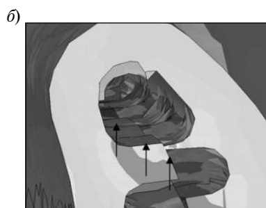
Рис. 10. Зоны локализации напряжений при первой ( a - f_1 = 633,2 Гц) и третьей ( b - f_3 = 2626 Гц) собственных формах колебаний лопатки
