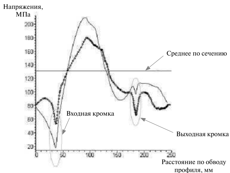
Рис. 2. Распределение значений интенсивности напряжений \sigma , по контуру для изотропного и анизотропного материалов ( ————— — изотропный материал; \diamond\diamond\diamond\diamond\diamond\diamond — анизотропный материал)
