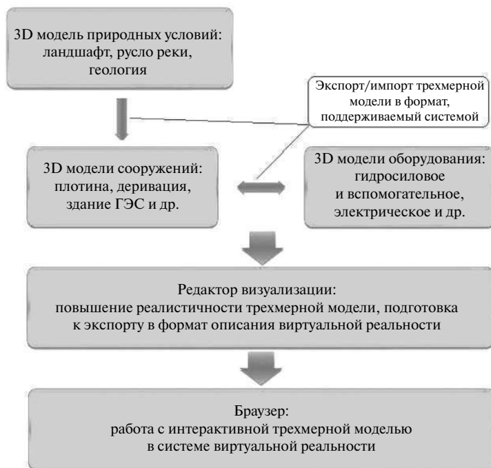
Рис. 2. Алгоритм экспорта трехмерных моделей из CAD систем для последующей визуализации
