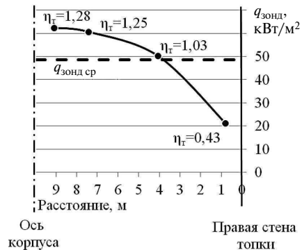
Рис. 5. Коэффициенты неравномерности и профиль плотностей воспринятого теплового потока
