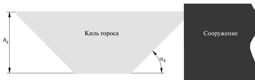
Рис. 2. Схема взаимодействия килля тороса с сооружением
