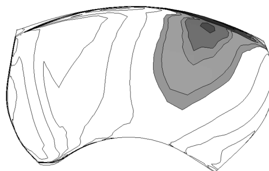
Рис. 15. Распределение давления по тыльной поверхности лопасти i13 ( W_{cav} = 0,2149 )
