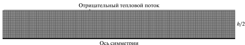
Рис. 2. Граничные условия в программе Deform-2D
