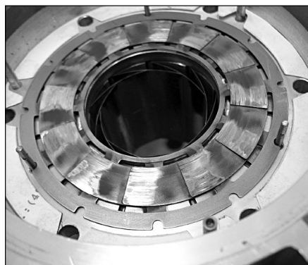
Рис. 9. Опорно-упорный лепестковый газодинамический подшипник в корпусе турбодетандерного генератора
