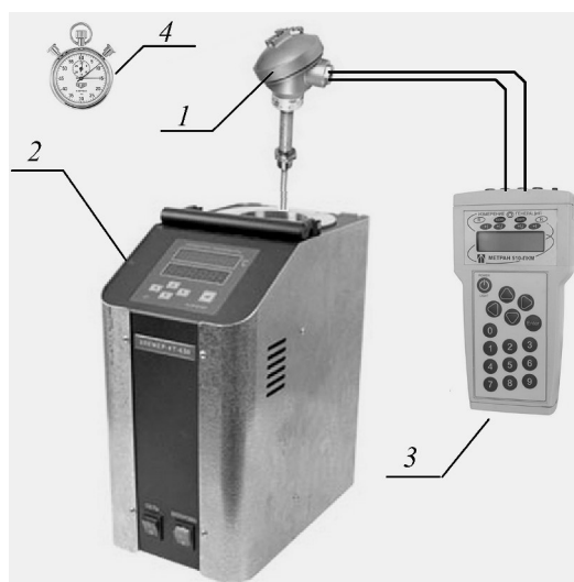
Рис. 3. Схема экспериментального стенда: 1 — ТЭП; 2 — сухоблочный калибратор температуры; 3 — многофункциональный калибратор; 4 — секундомер
