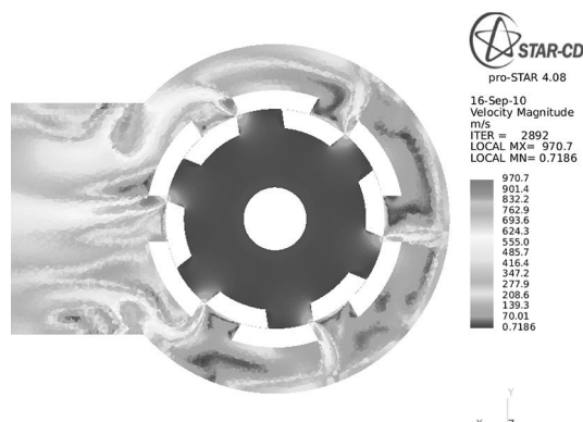
Рис. 10. Распределение скорости в среднем сечении окон (ПЗК закрыт, входной патрубков не показан); реверсивное направление течения
