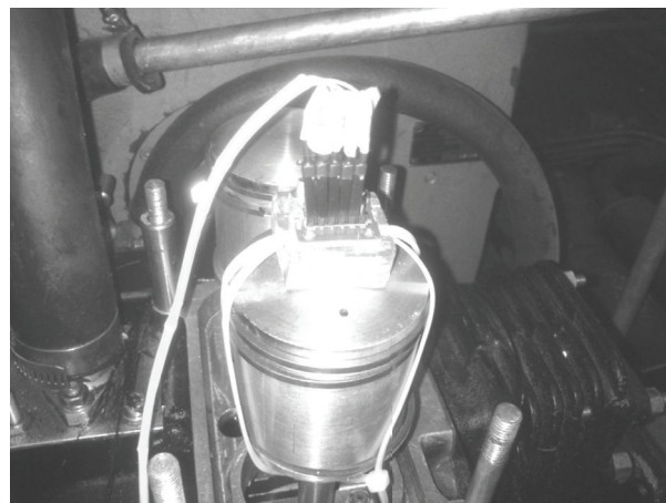
Рис. 6. Поршень с установленным датчиком
