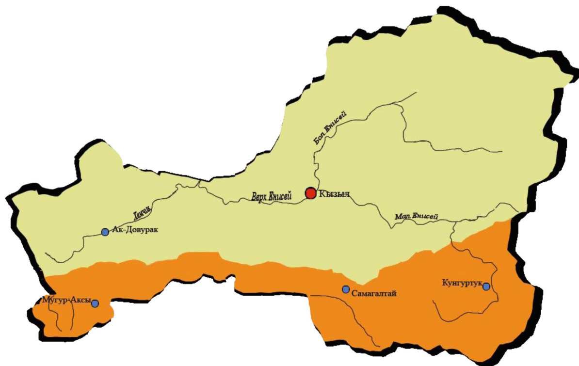
Рис. 4. Районирование территории республики Тыва по солнечным зонам с учетом физико-географических особенностей рельефа местности (■ – I зона 1300–1400 кВтч/кв.м; ■ – II зона 1200–1300 кВт ч/кв.м)
