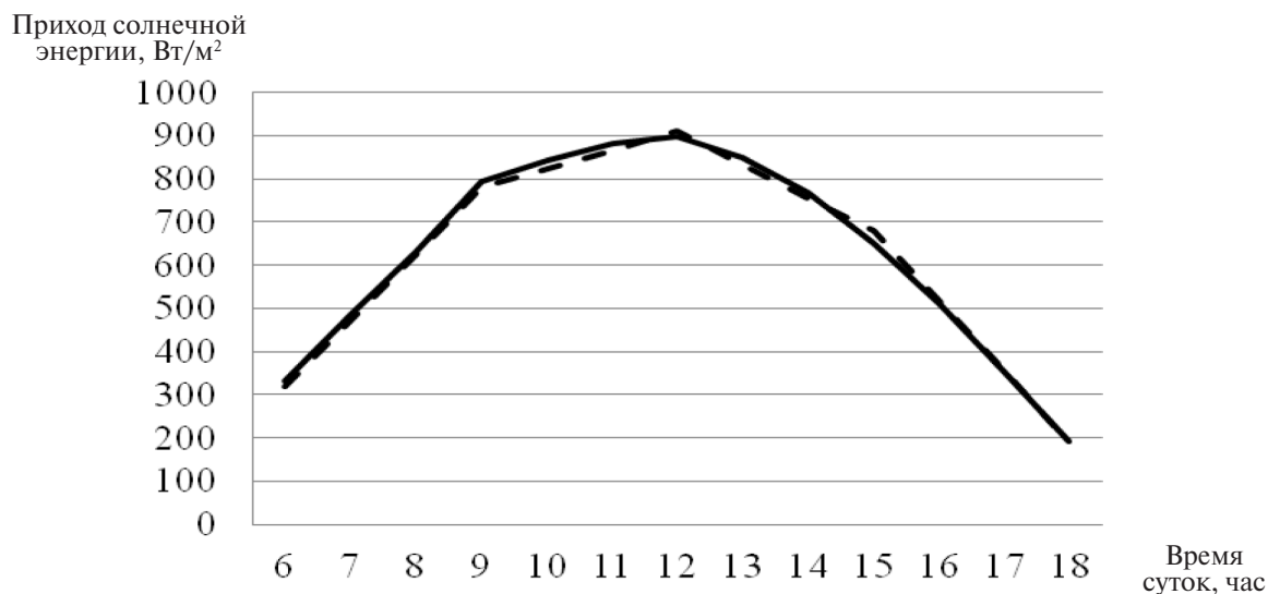
Рис. 2. Значения суммарного прихода солнечной энергии на горизонтальную поверхность на 15 июля, Вт/м² (сплошная кривая – расчетные значения; пунктирная кривая – реальные значения)
