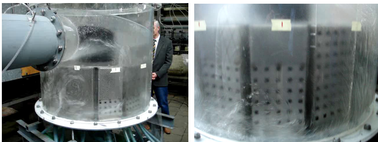
Рис. 6. Исследование пространственного распределения воздухо-водяного потока в экспериментальном стенде (третий этап)
