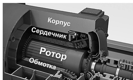
Рис. 1. Схема конструкции турбогенератора
