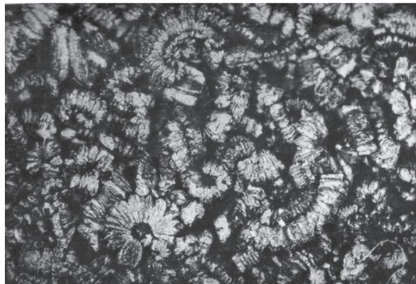
Рис. 3. Микроструктура образца, полученного при давлении 0,023 МПа ( \times 50 )
