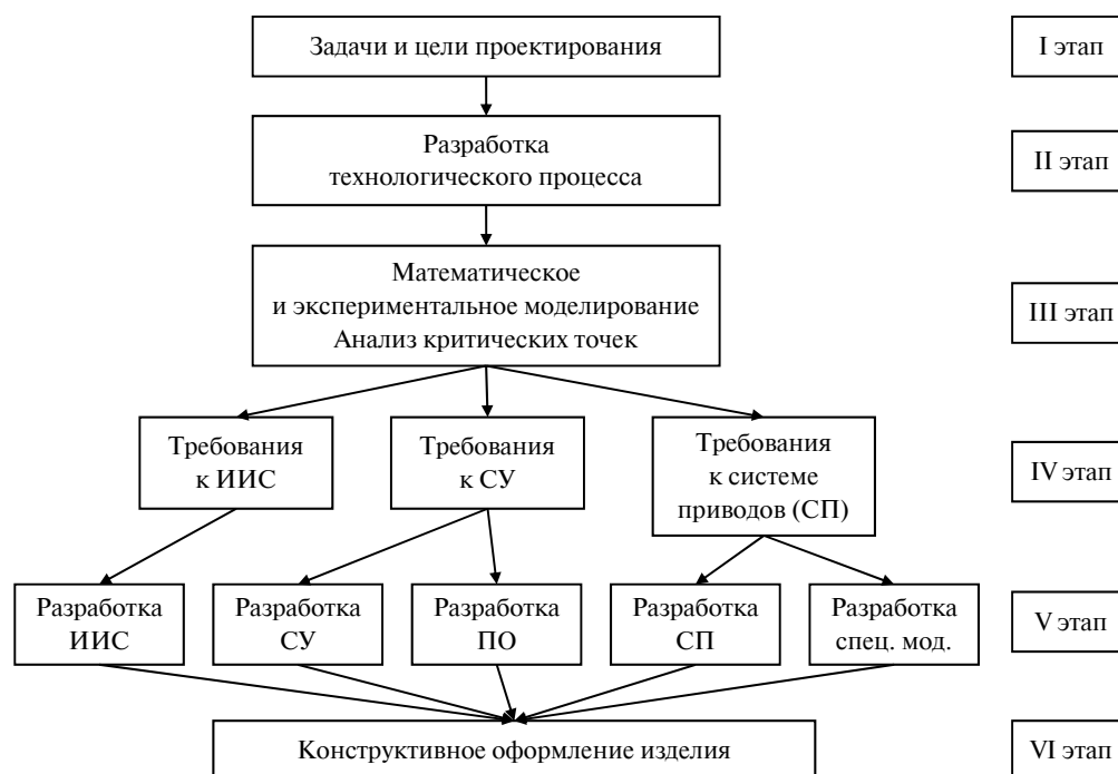
Рис. 3. Последовательность проектирования мехатронного технологического оборудования Fig. 3. The sequence of the design of mechatronic process equipment
