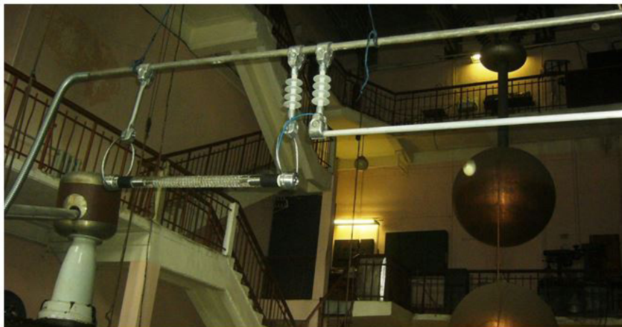
Рис. 7. АППС-С: лампа с арматурой на макете однофазной линии 190 кВ Fig. 7. APPS-S: lamp with fittings on the model of a single-phase line 190 kV
