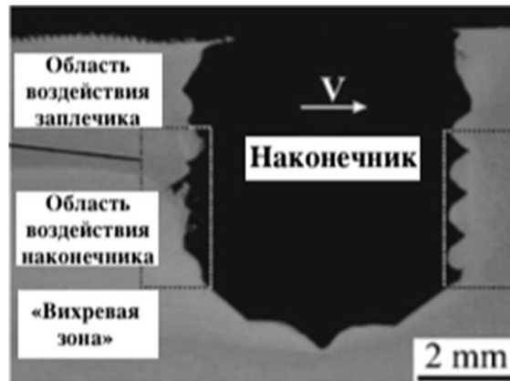
Рис. 7. Продольное перпендикулярно плоскости листа сечение шва СТП со сломанным наконечником инструмента, оставшимся в материале [6]
