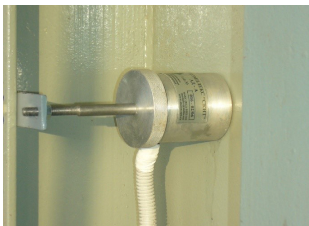
Рис. 3. Внешний вид акустического датчика ЧР Fig. 3. Top view of the acoustic PD sensor
