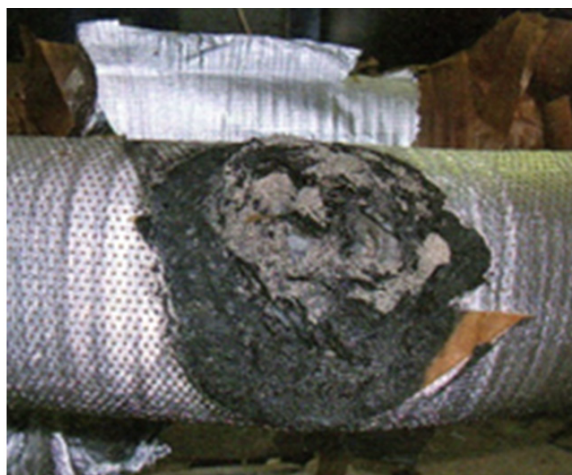
Рис. 2. Аналогичное повреждение ТТ типа IBM-500 [1]. Повреждения в эксплуатации происходят, если в течение 1-го месяца днём стоит жаркая погода с температурой в тени 25-30°C. Ночью температура снижалась.
