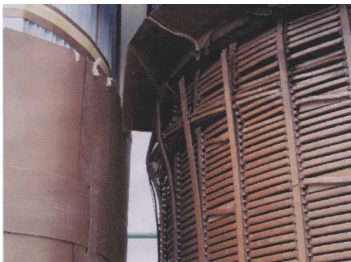
Рис. 5. Разрушение обмотки 500 кВ с внешней стороны тр-ра Тяньваньской АЭС
