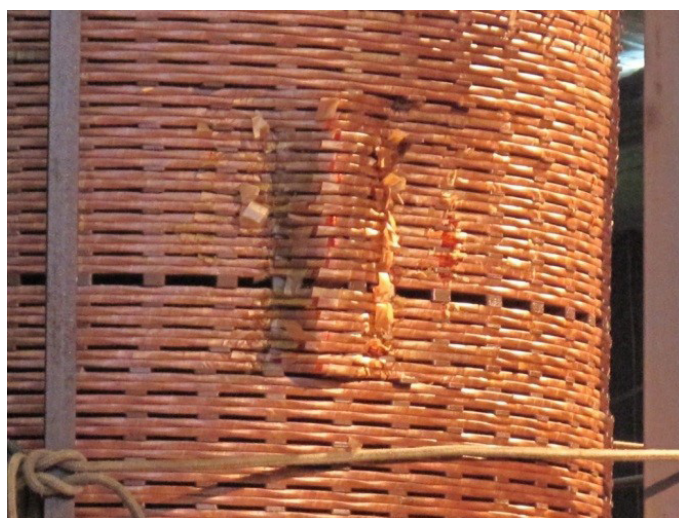
Рис. 7. Начало повреждения обмотки 500 кВ тр-ра 1Т 500 кВ, 1000 МВА Сургутской ГРЭС-2 Fig. 7. Initial stage of 500 kV winding damage of power transformer 1Т 500 kV, 1000 MVA Surgut power plant GRES-2
