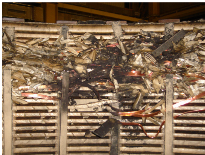
Рис. 6. Разрушение обмотки 500 кВ с внутренней стороны Тяньваньской АЭС
