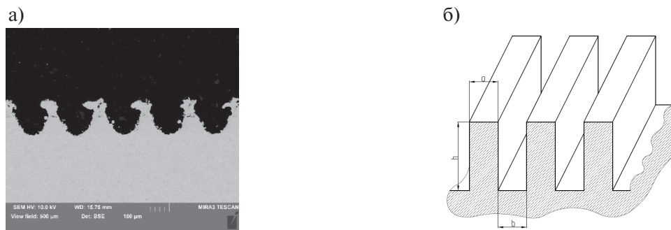
Рис. 2. Характерный внешний вид (а) и упрощенная геометрическая модель (б) сформированного на поверхности экспериментальных образцов из нержавеющей стали рельефа
