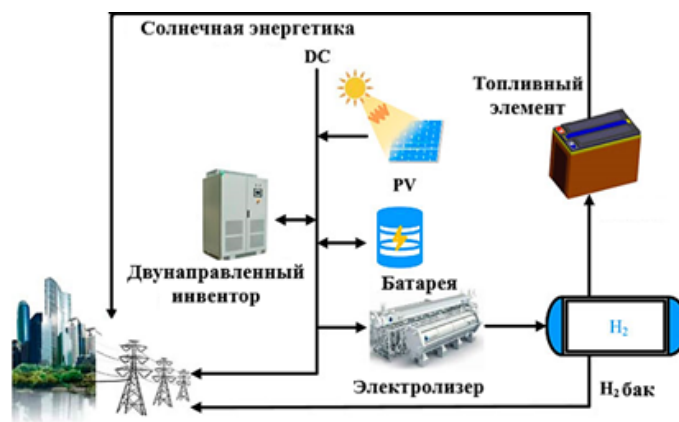
Рис. 1. Мультиэнергетическая комплементарная система хранения энергии на основе водорода
