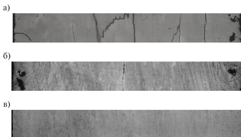
Рис. 1. Трещины вдоль поперечного сечения по направлению построения (BD) образца: а) 1; б) 2; в) 3 Fig. 1. Cracks along the cross section in the direction of construction (BD) of the sample: а) 1; б) 2; в) 3
