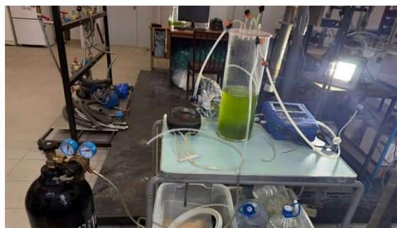
Рис. 2. Фотобиореактор для оценки скорости поглощения углекислого газа биомассой микроводорослей и схема эксперимента: 1 – фотобиореактор; 2 – распылитель; 3 – теплонагреватель; 4 – трубки; 5 – аэратор; 6 – система подачи \text{CO}_2 ; 7 – газоанализатор; 8 – система освещения
