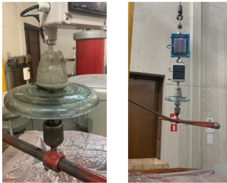
Рис. 10. Измерения токов утечки в лаборатории ЮАИЗ на демонтированных с ВЛ 110 кВ «Менделеево – Эра» изоляторах фазы А
