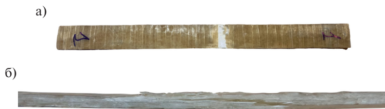
Рис. 1. Характерный внешний вид образцов после испытаний на растяжение: а) сверху; б) сбоку Fig. 1. Characteristic appearance of samples after tensile testing: a) top view; b) side view
