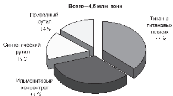
Рис. 2. Сырьевые источники производства диоксида титана
