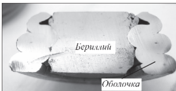
Рис. 6. Заготовка нанокристаллического бериллия, полученная после осадки на 80 %
