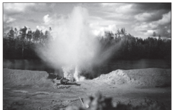
Рис. 4. Общий вид взрыва заряда гранулиита-Ж при взрыве бетонного блока
