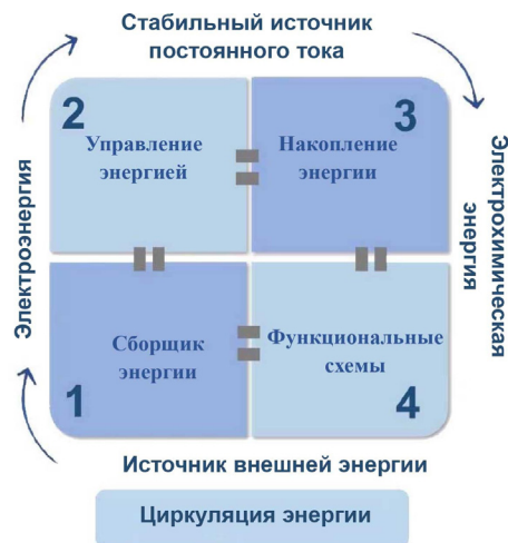
Рис. 2. Рабочий процесс устойчивой бумажной электроники также подразумевает циркуляцию энергии, включающую в себя преобразование окружающей энергии, накопление электрохимической энергии и использование энергии в функциональных схемах (в виде фотонной, тепловой, электромагнитной или механической энергии)
