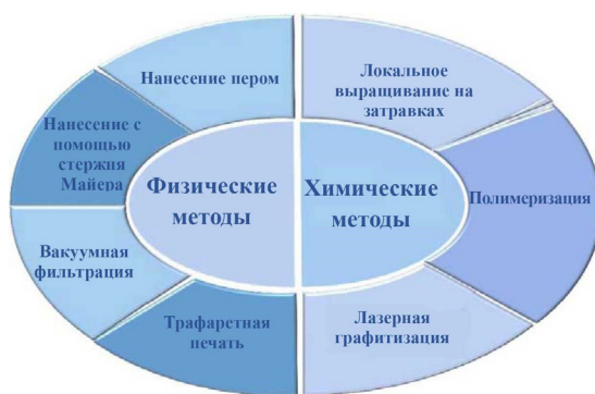
Рис. 4. Процесс обеспечения проводимости бумаги
