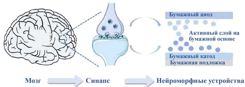
Рис. 9. Устойчивая бумажная электроника для передовой нейроморфной инженерии/вычислительных устройств
