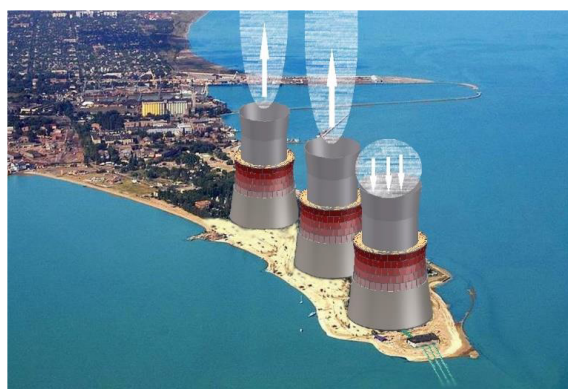
Рис. 1. Вариант полуостровного расположения мегасистемы «Кулер» для сбора атмосферной влаги (третий в ряду инжектор справа) и генерации высотной зонтичной облачности (первые два инжектора слева)
