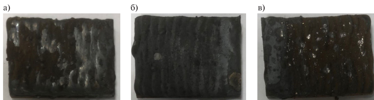
Рис. 2. Образцы после дуговой наплавки порошковыми проволоками: а – ПП-НП30Х4Г2М; б – ПП-НП80Х20Р3Т; в – ASM 4440-GS
