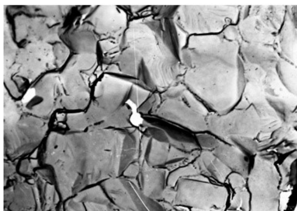
Рис. 4. Фрактография излома твердого сплава (96 % W 4% Co) после многократной, ступенчатой закалки по режиму 1, \times 1000
