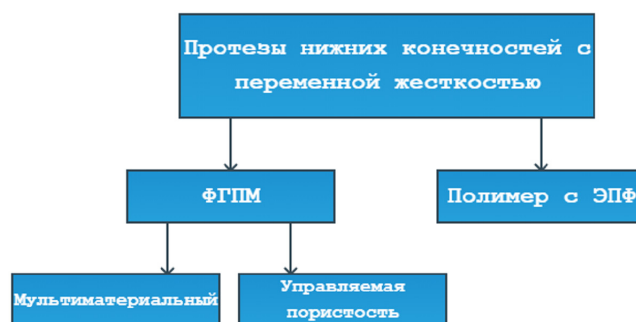
Рис. 2. Классификация возможных способов создания конструкции протезов нижних конечностей с переменной жесткостью с использованием АП
