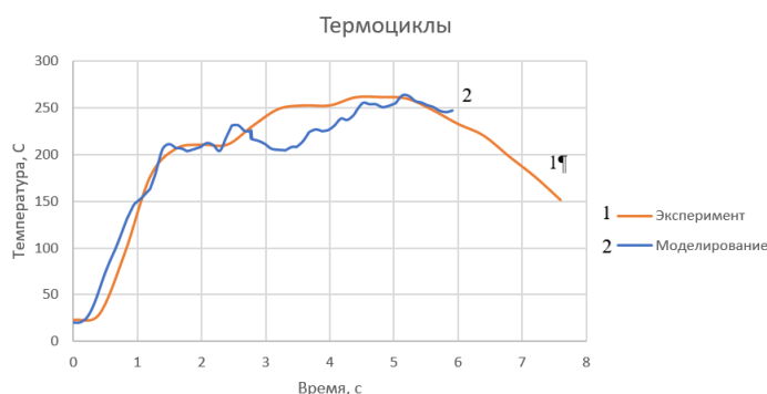
Рис. 2. Графики зависимости температуры от времени АМг5 экспериментально полученной кривой (1) и кривой, полученной при моделировании (2)
