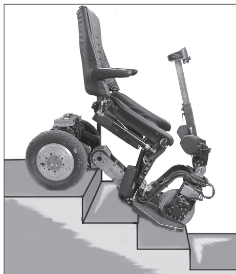
Рис. 4. Трансскутер “Кенгуру” при преодолении лестничного марша (спуск вниз)
