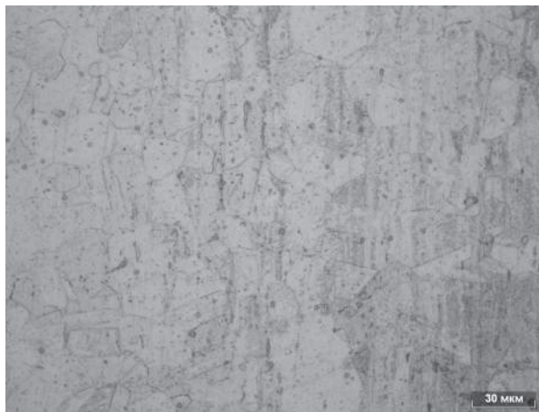
Рис. 7. Сталь 12X18H10T, исходная микроструктура ( \times 500 )
