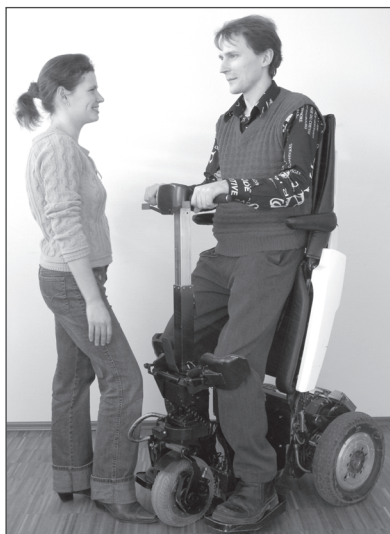
Рис. 3. Трансскутер “Кенгуру” в конфигурации “вертикаль”
