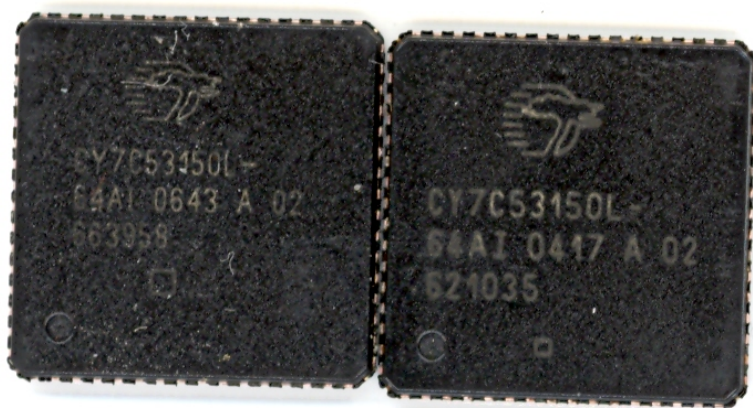
Рис. 3 Фотографии лицевой стороны корпуса бракованной (слева) и оригинальной (справа) микросхем CY7C5310L – 64AI.
