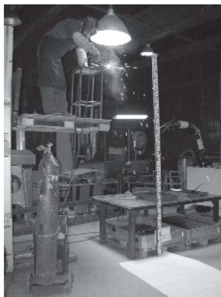
Рис.1 Измерение гравитационной гидравлической крупности w частиц пыли, выделяющихся при сварке
