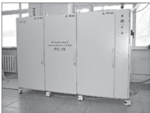
Рис. 4. Источники энергии лазерно-дугового технологического комплекса: а — иттербиевый волоконный лазер ЛС-15; б — источник тока ВДУ-506ДК
