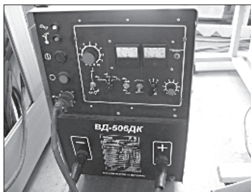
Рис. 4. Источники энергии лазерно-дугового технологического комплекса: а — иттербиевый волоконный лазер ЛС-15; б — источник тока ВДУ-506ДК
