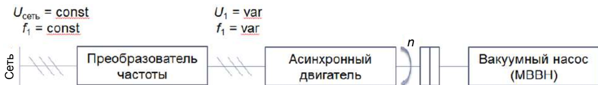
Рис. 7. Схема подключения электродвигателя к МВВН
