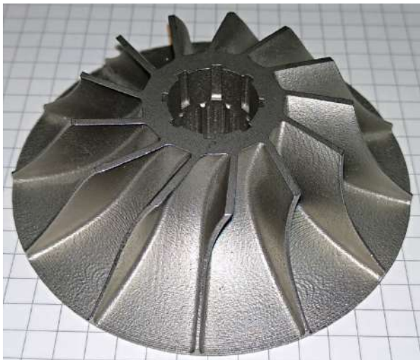
Рис. 1. Пример выполнения на 3D принтере рабочего колеса центробежного компрессора
