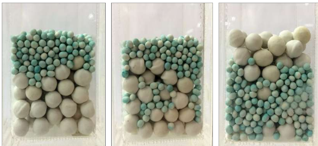
Рис. 1. Бесситовая вибрационная сегрегация Fig. 1. Unstitched vibration segregation
