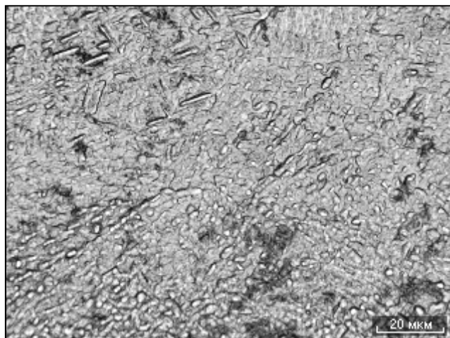
Рис. 9. Микроструктура ( \times 500 ) листа толщиной t = 10 мм из сплава VT23 после закалки от 850^\circ\text{C} и последующего старения при 500^\circ\text{C}
