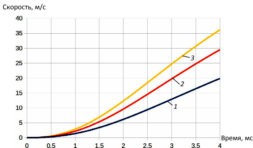
Рис. 4. Зависимость скорости разгона поршня от времени при наполнении камеры воздухом при различных параметрах входного давления (1 – 1 МПа, 2 – 2 МПа, 3 – 3 МПа)
