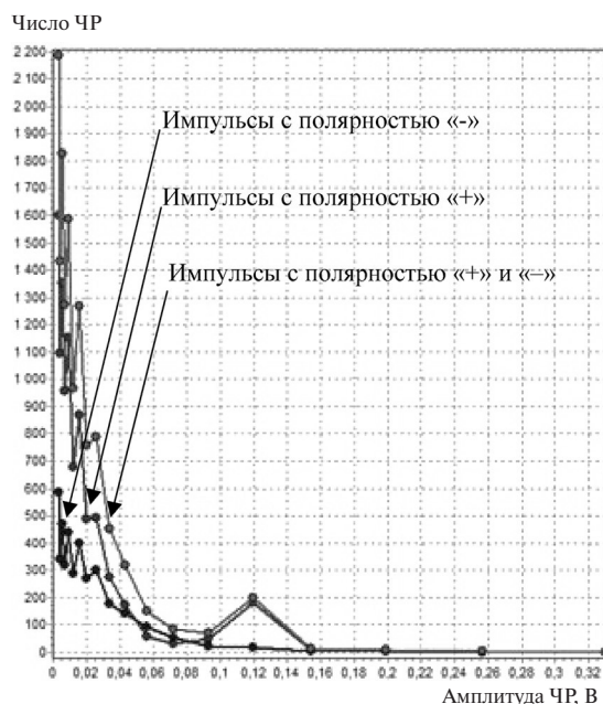
Рис. 4. Статистическое распределение ЧР типов 1 и 2 (увлажненный ПКИ, переменное напряжение 35 кВ; развертка по горизонтали: амплитуда в [1 \text{ В}] = [10^4 \text{ пКл}] ; развертка по вертикали: число ЧР)
