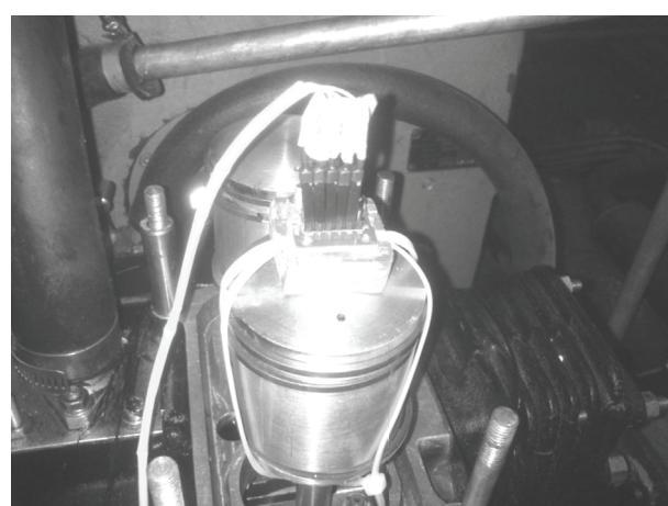
Рис. 6. Поршень с установленным датчиком
