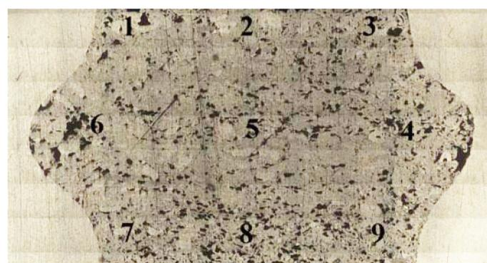
Рис. 17. Макроструктура порошковой заготовки после деформации 45 % (пористость: 1 – 0,259; 2 – 0,201; 3 – 0,234; 4 – 0,287; 5 – 0,226; 6 – 0,268; 7 – 0,262; 8 – 0,340; 9 – 0,247)
