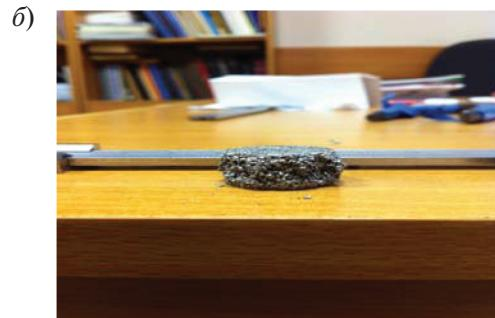
Рис. 15. Порошковая заготовка после деформации 20 % (а) и предельной деформации 30 % (б)
