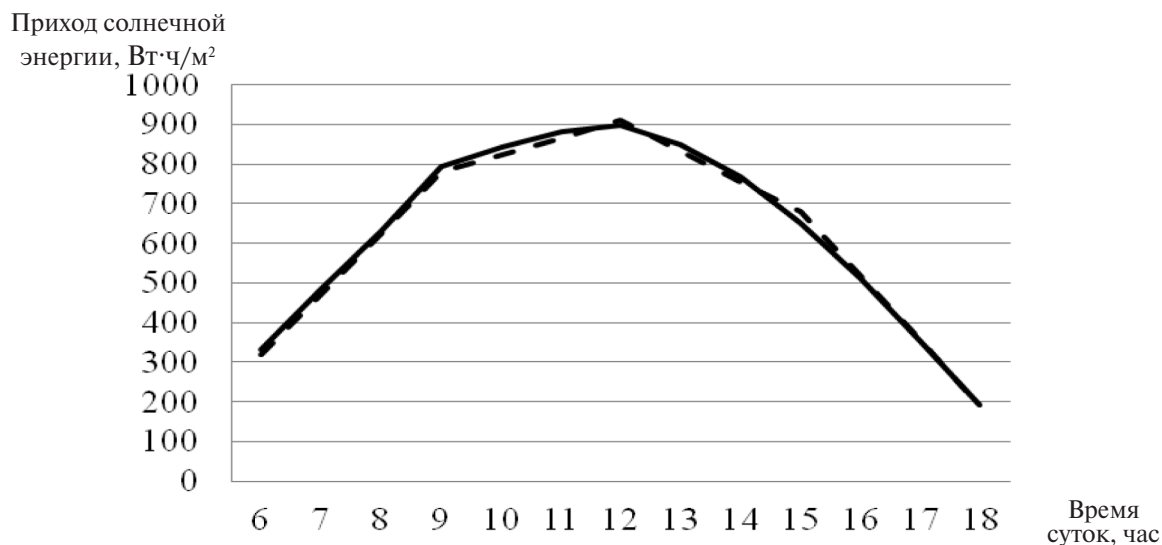
Рис. 2. Значения суммарного прихода солнечной энергии, Вт·ч/м², на горизонтальную поверхность 15 июля, Вт/м² (сплошная кривая – расчетные значения; пунктирная кривая – реальные значения)
