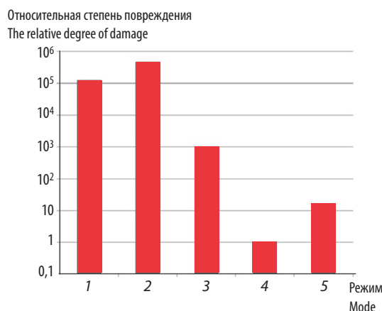
Рис. 3. Сравнительные ресурсные характеристики режимов эксплуатации. Режимы: 1 — холостой ход (SNL); 2 — малая частичная нагрузка (LPL); 3 — частичная нагрузка (PL); 4 — оптимум (VER); 5 — большая нагрузка (HL)
