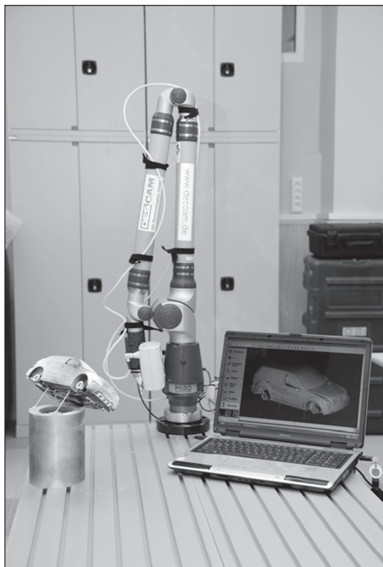
Рис. 5. 3D сканирование поверхности модели автомобиля
