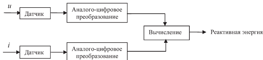
Рис. 1. Экспериментальная блок-схема измерения реактивной энергии путем аналого-цифрового преобразования величин напряжения и тока и последующей реализации математических формул реактивной мощности и энергии
