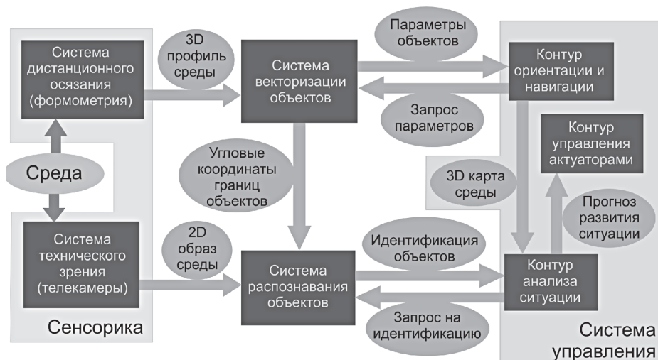
Рис. 2. Архитектура системы сбора и обработки координатной информации автономного робототехнического комплекса
