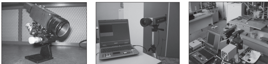
Рис. 1. Оптический блок системы «Регистратор» (слева), цифровая высокоскоростная камера CENTURIO C100 (в центре), линзовый спектрограф SL100M (справа)
