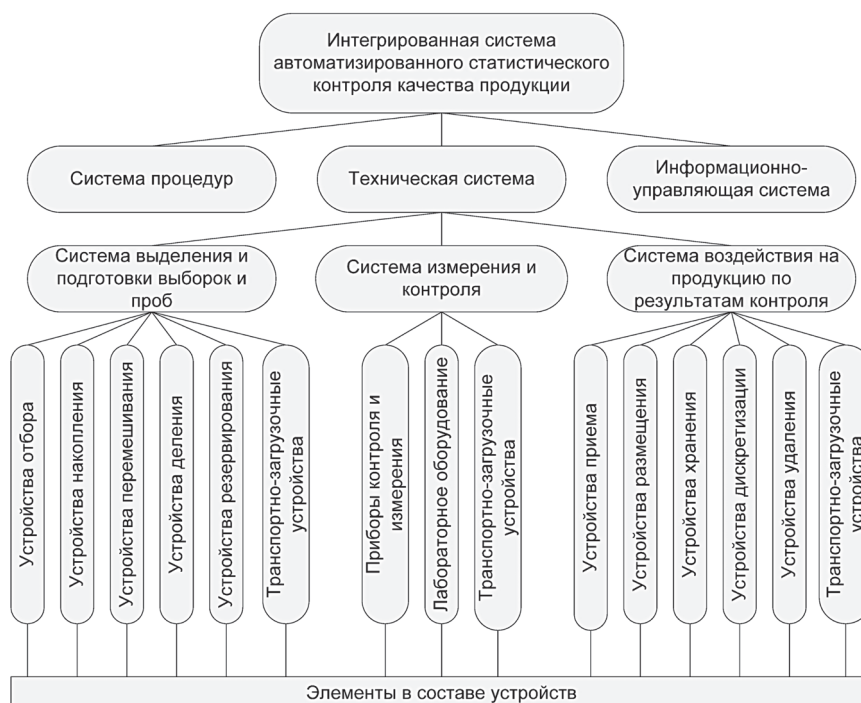
Рис. 2. Иерархическая модель структуры системы автоматизированного статистического контроля качества продукции
